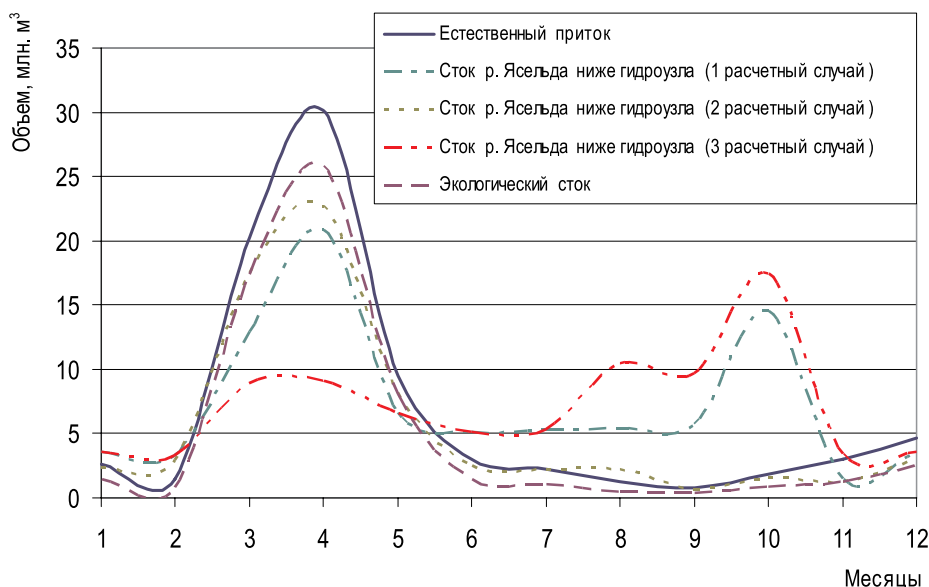
Рисунок 3. – Гидрограф объемов стока в створе гидроузла для различных расчетных случаев
